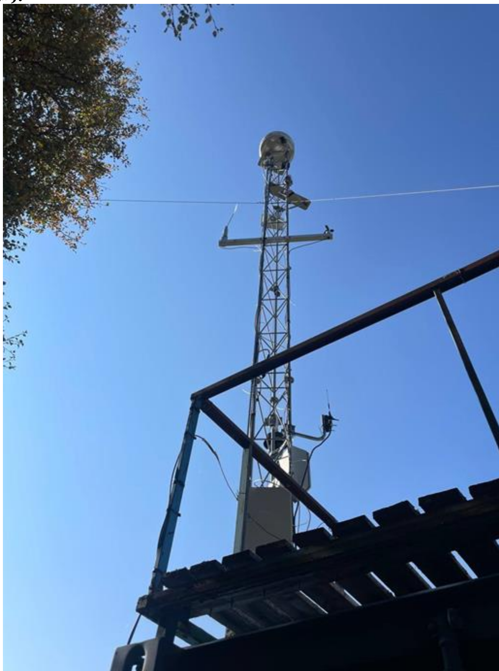
Рис.9 Станция автоматизированного мониторинга НАЯ «Голубая», основная рабочая мачта с навесным оборудованием
