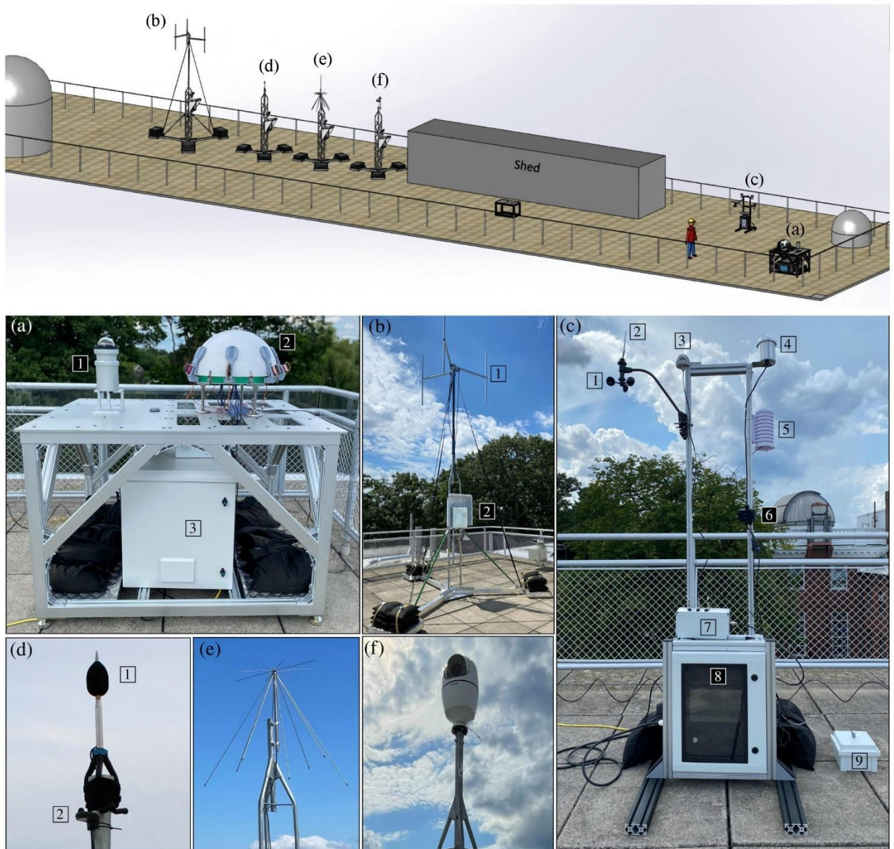
Рис.2 Схема расположения комплекса приборов обсерватории и их фотографии. В состав обсерватории входят: (а) 1. Камера для обзора всего неба ALCOR OMEA 9C; 2. Полусферическая матрица Dalek из 8 тепловизионных камер LWIR и одной оптической камеры, а также широкоугольной инфракрасной камеры для обзора всего неба; 3. Корпус, защищенный от атмосферных воздействий, для соединенных с приборами компьютеров; (б) Радарная мачта SkyWatch - 1. дипольная антенная решетка; 2. корпус с электроникой; (с) Система экологического мониторинга NPASCKMAN - 1. анемометр; 2. флюгер для измерения скорости и направления ветра; 3. дождемер; 4. оптическая камера для обзора всего неба; 5. датчики температуры и давления; 6. блок предохранителей/переключателей; 7. счетчик частиц; 8. модуль питания и передачи данных; 9. магнитометр; (d) 1. Звуковой микрофон GRAS; 2. Ультразвуковой микрофон Wildlife Acoustics (инфразвуковой датчик не показан); (e) Широкополосная антенна Discone для анализатора спектра Spectre; (f) камера Beacon 8 с узким полем обзора, панорамированием, наклоном и зумом. Специалисты рассчитывают развернуть в ближайшее время до десяти таких же или похожих обсерваторий в разных регионах США с разными условиями наблюдений (пустыня, горы, населенная местность и т. п.), а также в местностях, где особенно часто замечают НАЯ. Точные координаты обсерваторий будут засекречены для обеспечения сохранности приборов и во избежание попыток обмануть систему. Предполагается также создать второстепенные площадки для размещения дополнительных датчиков, работающих синхронно с основными обсерваториями.
