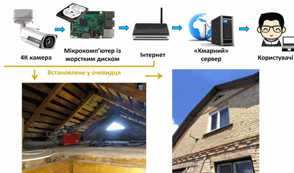
Рис. 1. Структура комплексу МА-1 для реєстрації ААЯ
