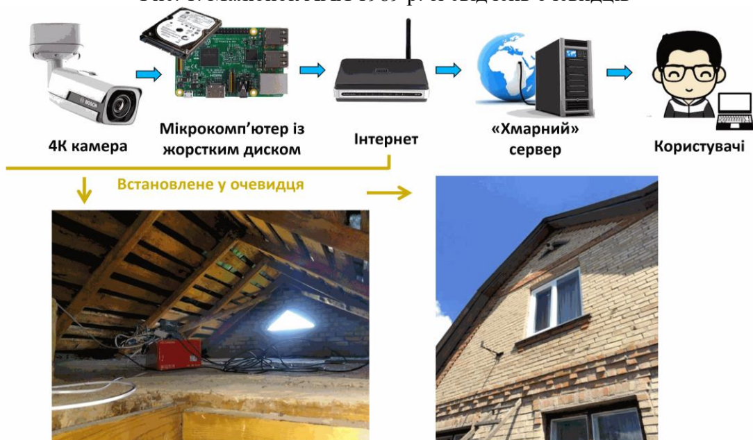
Рис. 2. Моніторинговий комплекс МА-1
