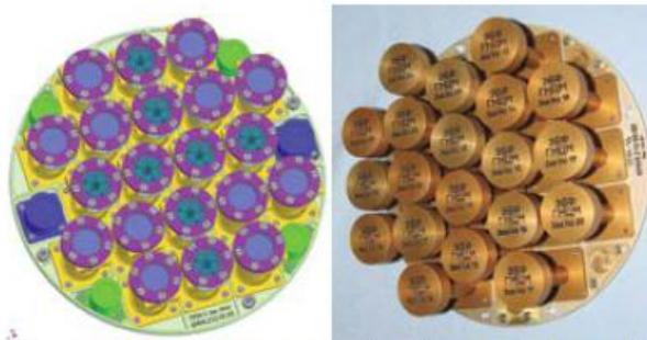
Плата полезной нагрузки (ППН) с установленной научной аппаратурой «Абиогенез» (образец оргстекла с биоматериалами, нанесенными на его поверхность) и «ЭкзобиоФрост» (образцы мерзлотных грунтов). Слева – 3D-модель, справа – реальный образец.
