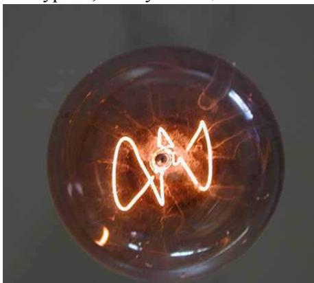
вручную сделан мастерами-стеклодувами, а нить накаливания сделана из углерода. Мощность лампочки всего 4 ватта. Она используется для ночного освещения в гараже для пожарных машин.
