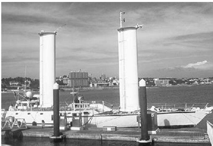
В сравнении с лучшими из обычных парусов (теми, например, что используются на Кубке Америки) турбопарус обеспечивает в 3,5-4 раза больший коэффициент тяги. Такой результат был получен в ходе исследований на «Алсионе».
