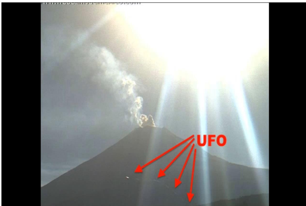
Рис.34.«НЛО» в виде скола на поверхности объектива и царапина в виде «шлейфа от НЛО».
