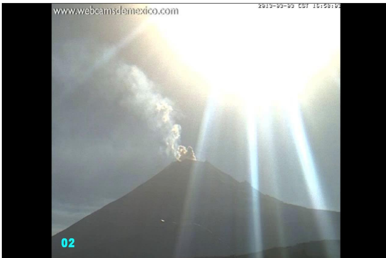
Рис.33.Видеокадр с проявившимся дефектом на линзе объектива веб-камеры.
