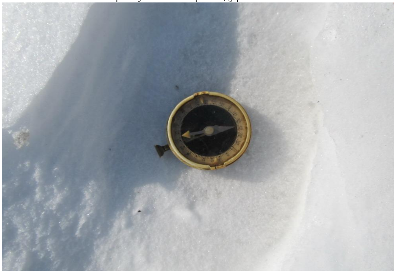
Рис.22.Не верное указание севера между рельсами там же.
