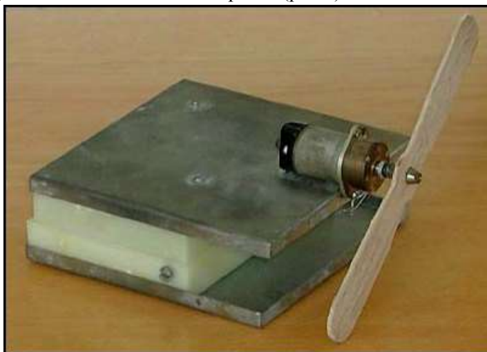
Рис. 7. Приемник для демонстрации беспроводной передачи энергии
