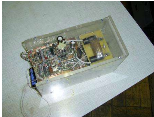
Рис. 9. Готовое устройство. Здесь видна управляющая плата, трансформатор и диод импульсного преобразователя. Можно видеть также кнопку выстрела S2.
