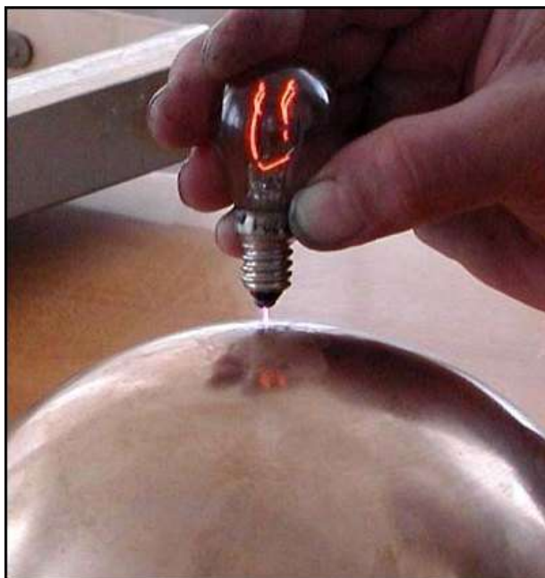
Рис. 13. Свечение лампы накаливания 220В, 15Вт в руке
