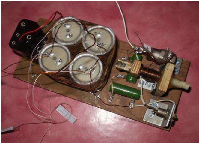
Рис. 8. ЕМ-1 на этапе сборки. Видны батарея силовых конденсаторов, аккумуляторный бокс, силовой и сбросовый тиристоры, мощные резисторы схемы автосброса и ускоряющая катушка. Сзади к катушке прикреплён постоянный магнит, удерживающий снаряд перед выстрелом.
