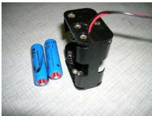
Рис. 2. Источник питания EM-1. Батарейный бокс на 6 аккумуляторов и два Ni-Cd аккумулятора на 600 мА·ч
