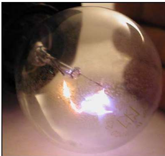
Рис. 11. Свечение перегоревшей лампы накаливания 220В, 60 Вт
