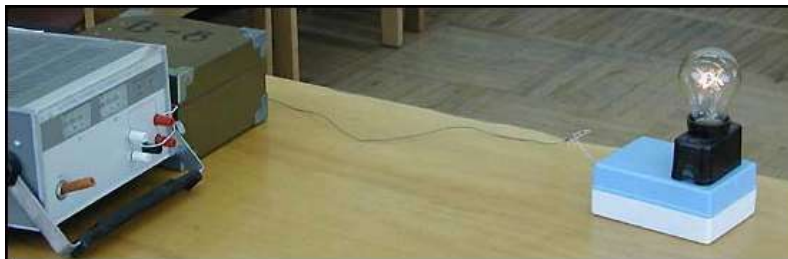
Рис. 3. Общий вид устройства для демонстрации однопроводной передачи энергии
