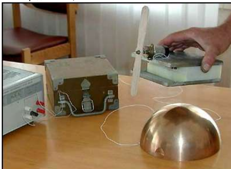
Рис. 6. Общий вид устройства для демонстрации беспроводной передачи энергии
