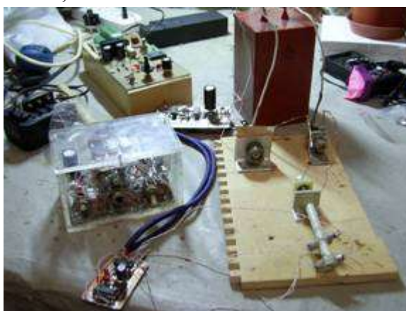
Рис. 1. Один из опытных образцов Gauss Gun. Видны плата управления тиристорами, мощный конденсатор (здесь я использовал комбинированный К75-40 на 1000В, 100 мкФ), источник высокого напряжения, ствол гауссовки с укрепленными ИК-датчиками, и ИК-хронограф.
