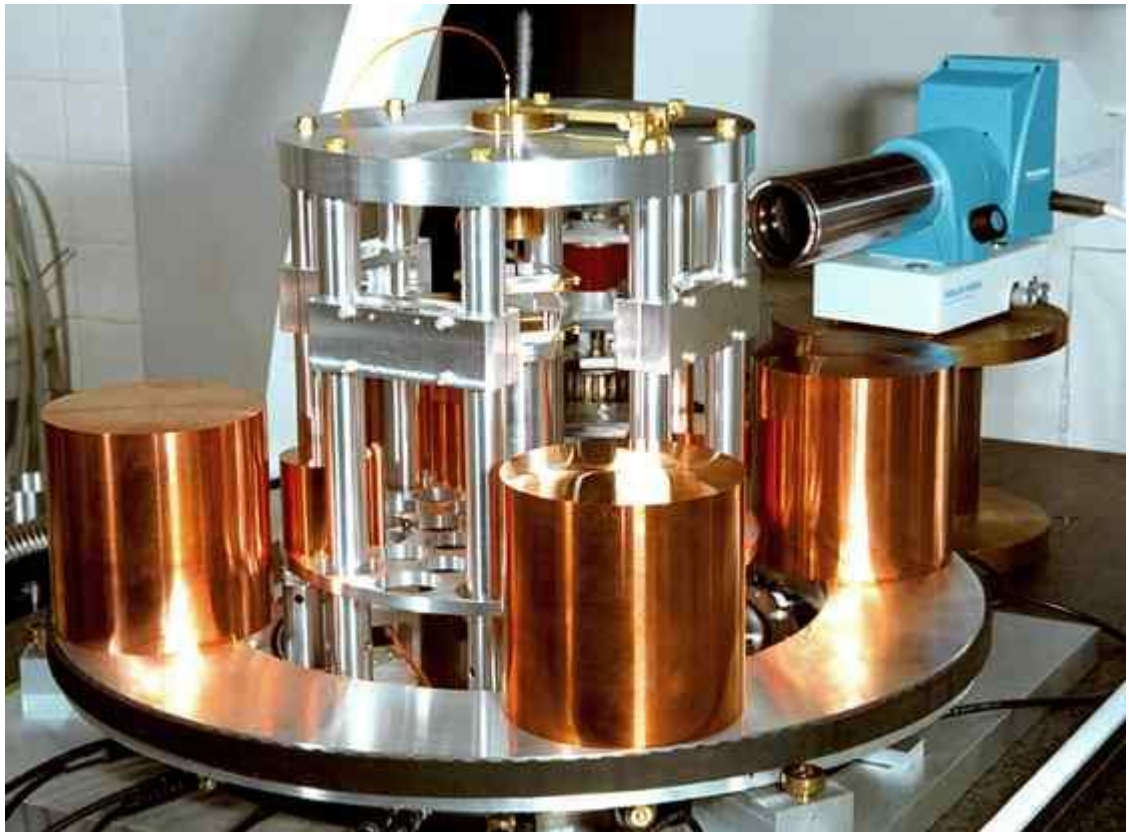
Рис.1. Установка, изготовленная в Международном бюро мер и весов, на которой было выполнено новое измерение гравитационной постоянной. Фото с сайта www.bipm.org
