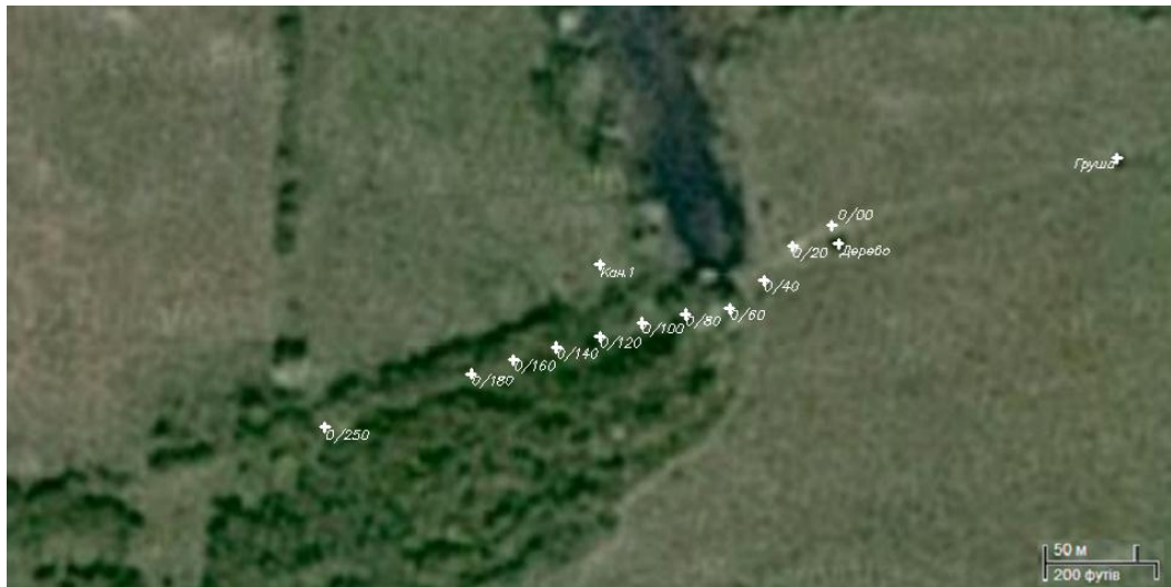
Рис. 1. Посадка точек-реперов схемки показаний магнитометра и отбора проб на спутниковый снимок местности
