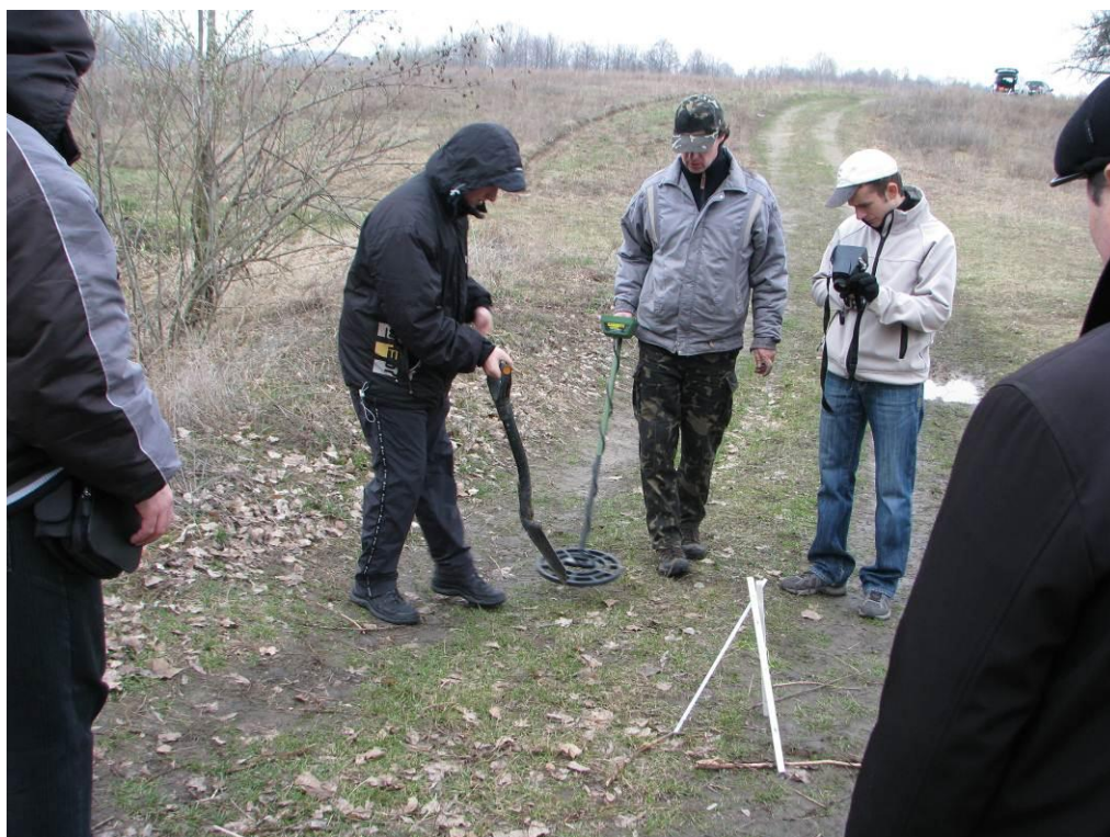
Рис.4. Обследование поверхности почвы с помощью металлоискателя и тепловизора
