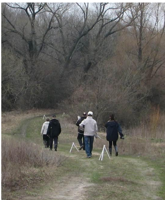
Рис.2. Разметка местности для нивелирного хода. Рис.3. Нивелирная съемка
