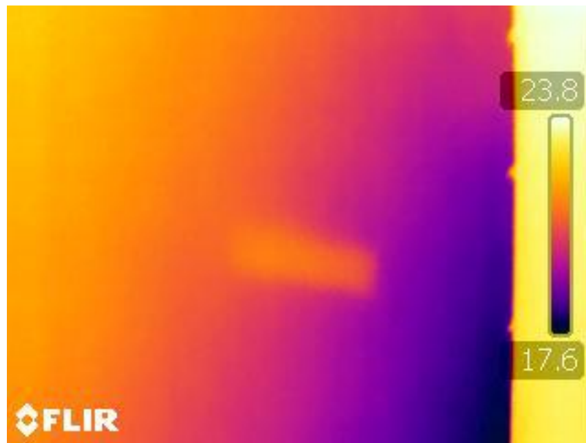
Рис.2. Закладная деревянная деталь в стене.
