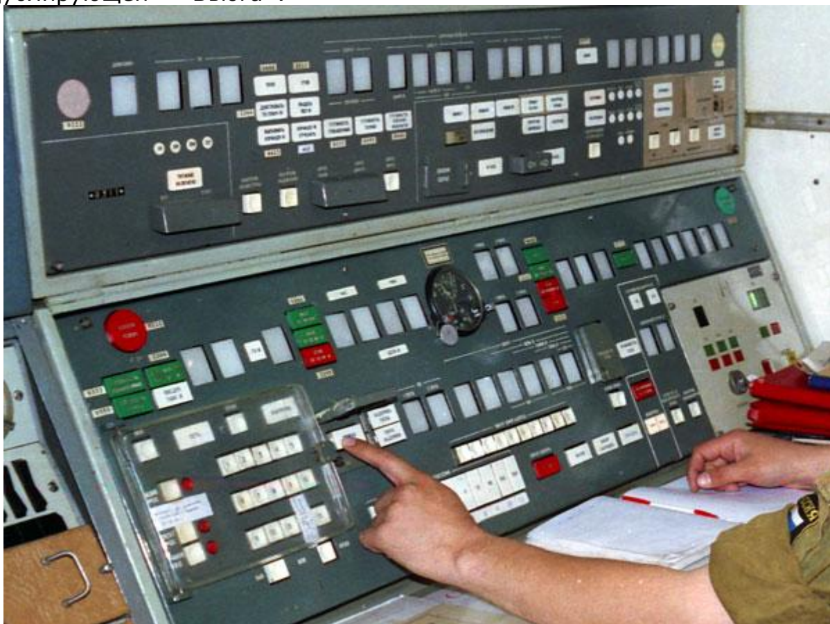
Сверху табло аппаратуры АСБУ 153967М "Вьюга", снизу пульт АСБУ 153781 «Сигнал-М».
