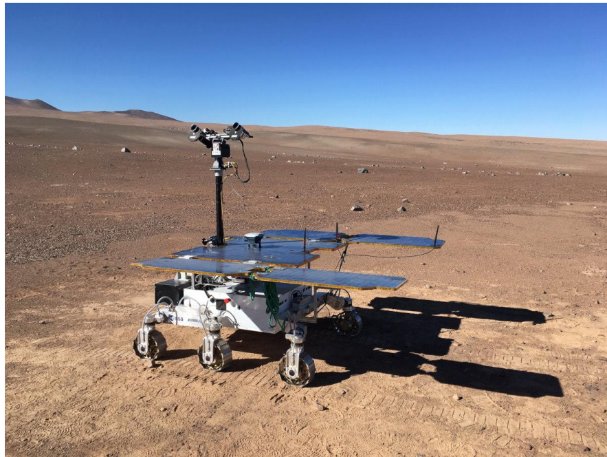
Рис.41. Випробувальна модель майбутнього марсохода ЄКА Розалінд Франклін, який має здійснити посадку на Марсі у 2021 році. Airbus
