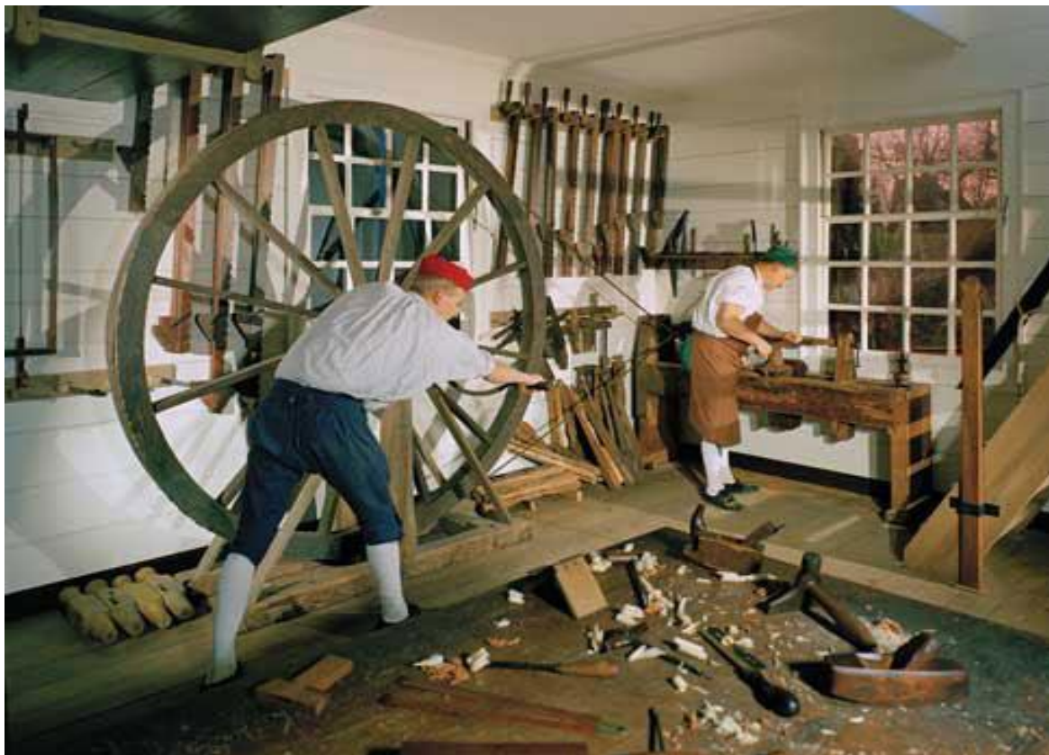
Рис.32. Токарний верстат з канатним ручним приводом від маховика
