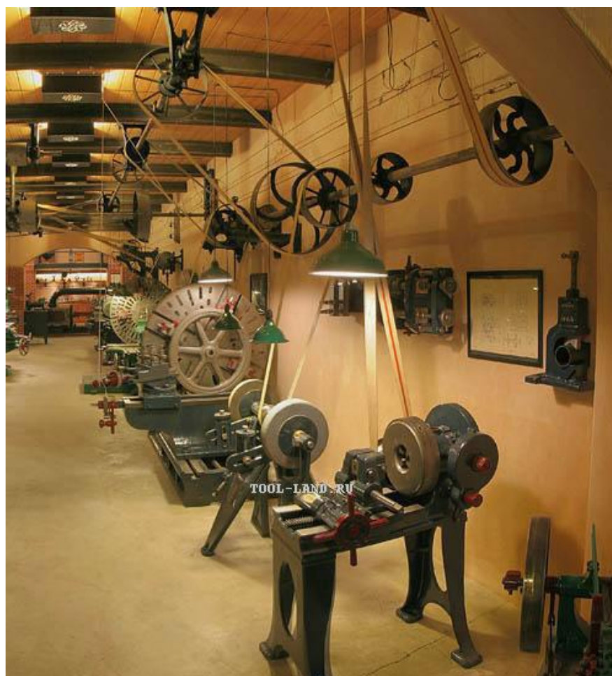
Рис.33. Система передачі обертального руху від, наприклад, парової машини
