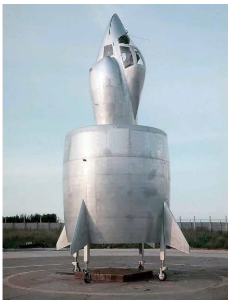
Рис.3. Дослідження літаків вертикального взлету і посадки “колеоптер” у Франції в 1954р., фірмою VTZ (технічне бюро Г. Зборовського)
