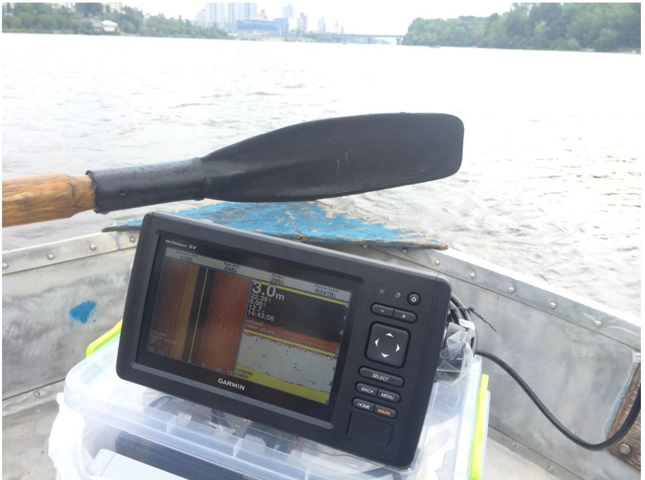
Рис. 12. Тестування обладнання 3D ехолоту в умовах, максимально наближених до польових.
