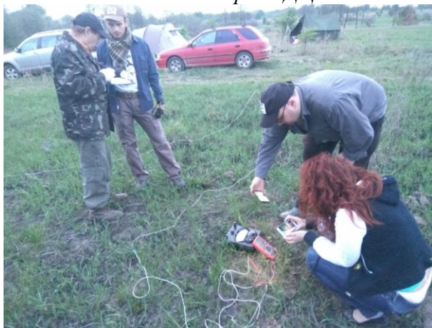
Рис. 8. Вимірювання напруженості електричних потенціалів ґрунтів ведуть експерти УНДЦА
