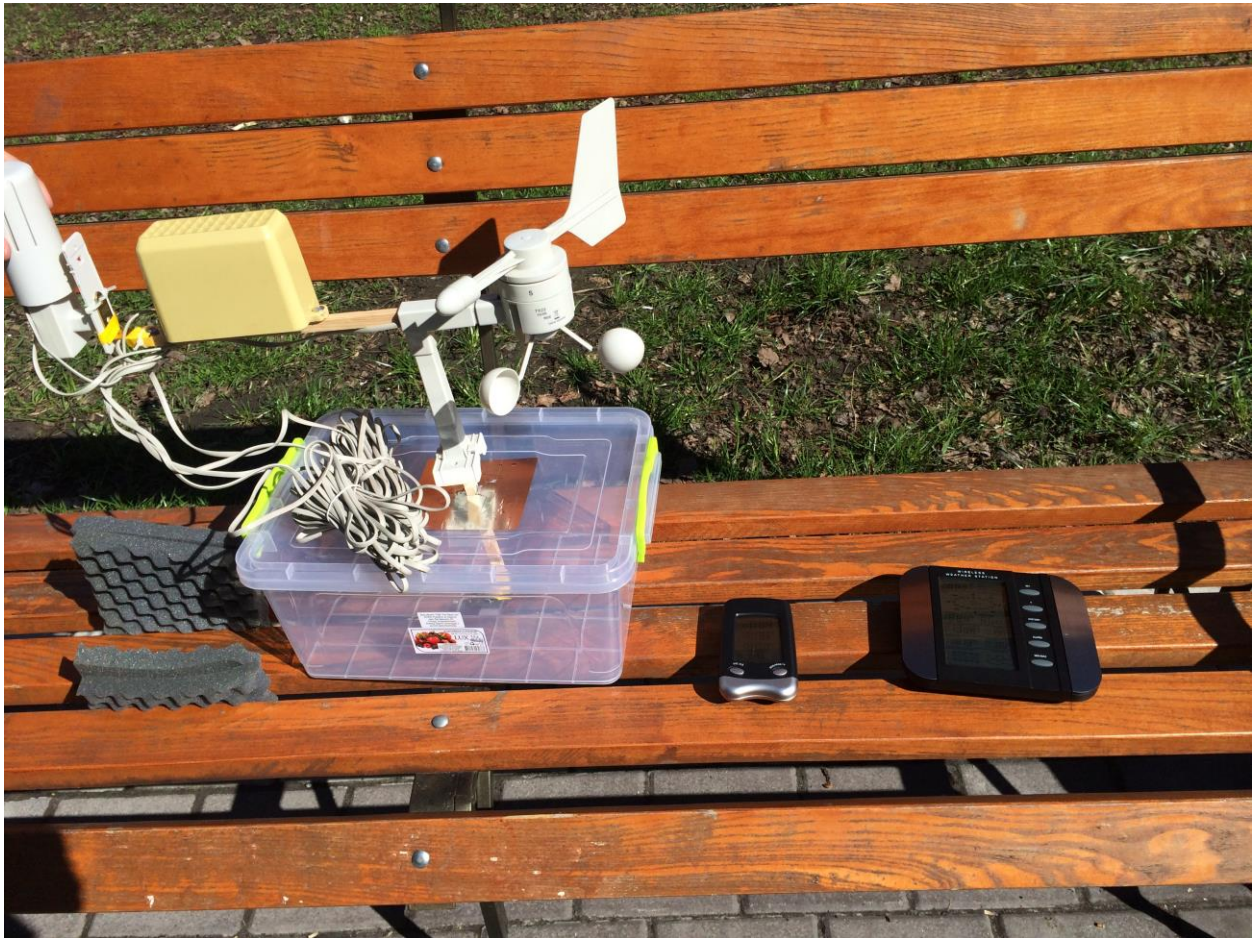
Рис.5. Метеостанція УНДЦА у зібраному стані
