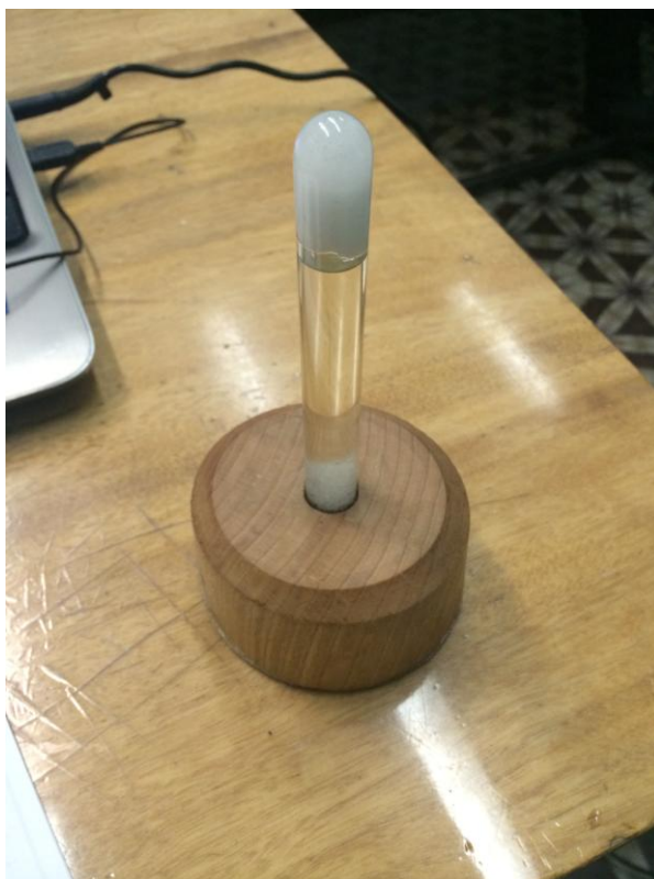
Рис.4. Прототип діючої корисної моделі приладу «Штормглас», розроблений УНДЦА
