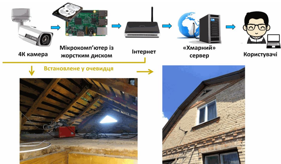
Рис.5. Структура комплексу МА-1 для реєстрації ААЯ
