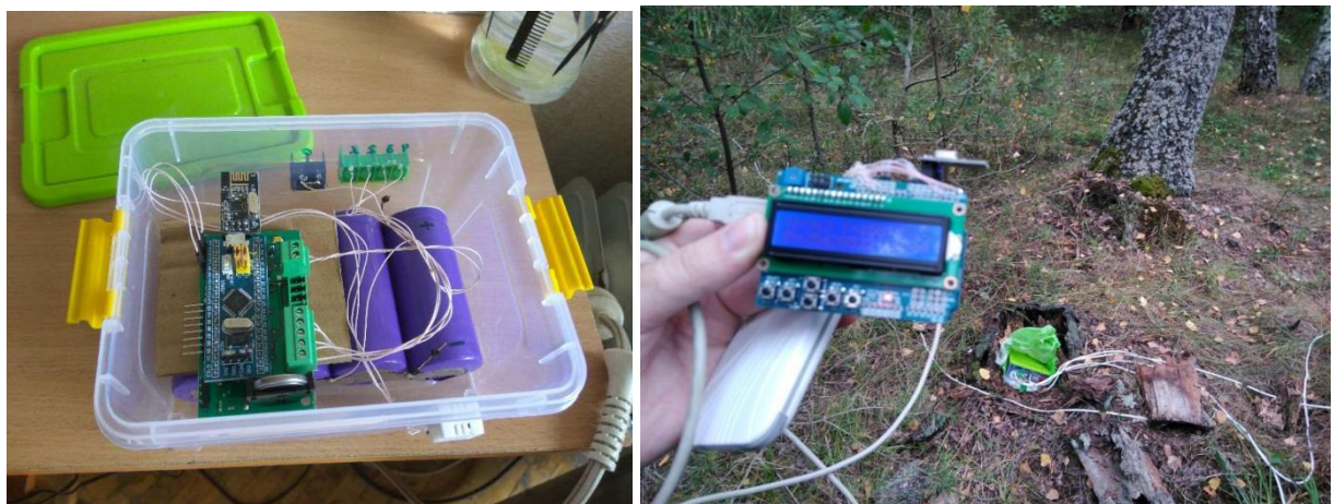
Рис.1. Зовнішній вигляд приладу МФ-2, встановлення МФ-2 на місцевості
