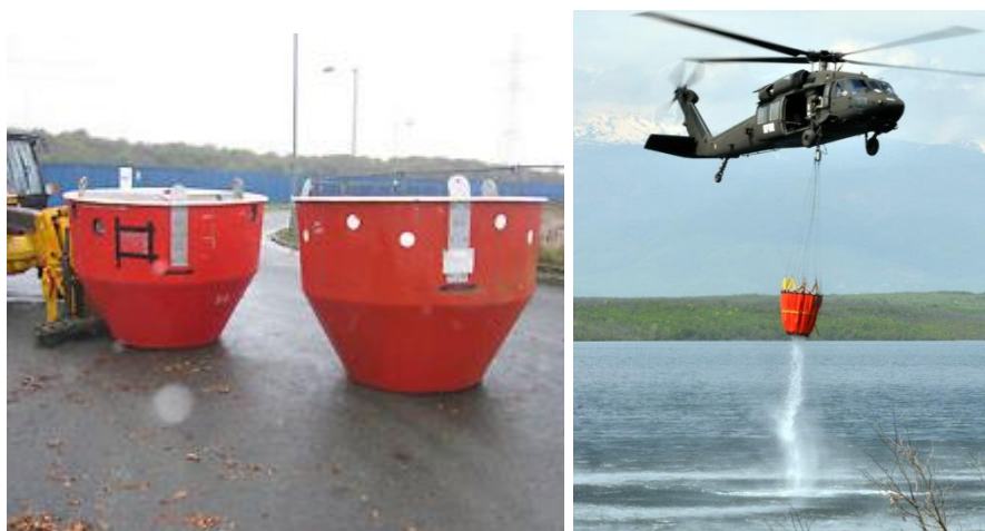
Рис.39. Модифікації підвісу пожежегасіння А, підвіс BAMBI BUCKET при наборі води (гелікоптер Чінук) Б
