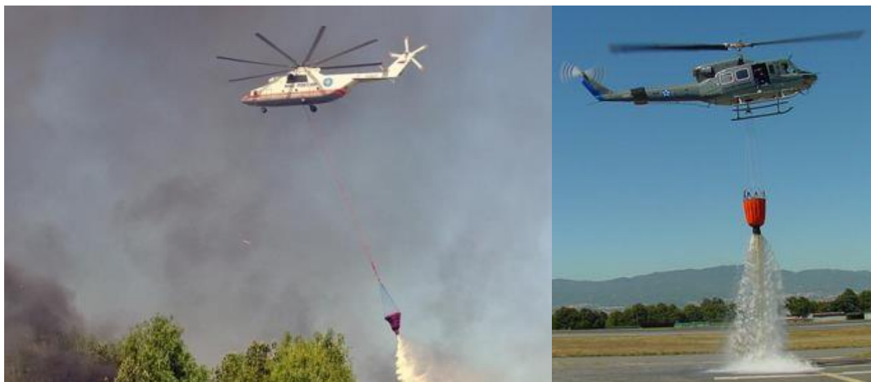
Рис.38. Пожежний вертоліт Ми-26ТП із підвіскою пожежегасіння Vambi-Bucket A ; демонстрація роботи Vambi-Bucket Amp 174 Gaam Australia Б
