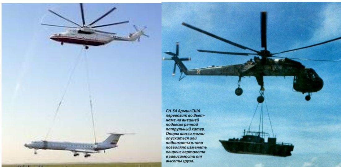
Рис.35. Гелікоптер Ми-8 Т із вантажем на зовнішній підвісці, Гелікоптер Sikorsky CH-54 / S-64 Skycrane
