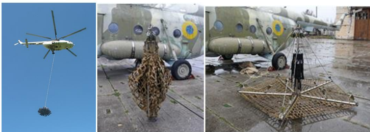
Рис.37. Комплект зйомного бортового обладнання "Адаптер-М1" для евакуації до 10 людей
