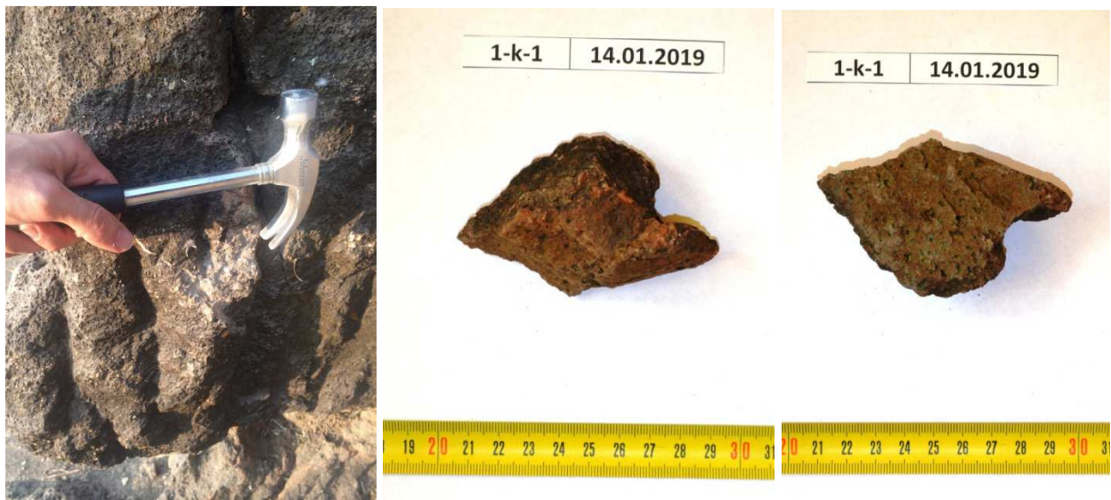
Рис.5.1.8. Піддатливість до обробки породи масиву гори, в якій вирізано храм; відібрані зразки (Див. також дод.2)
