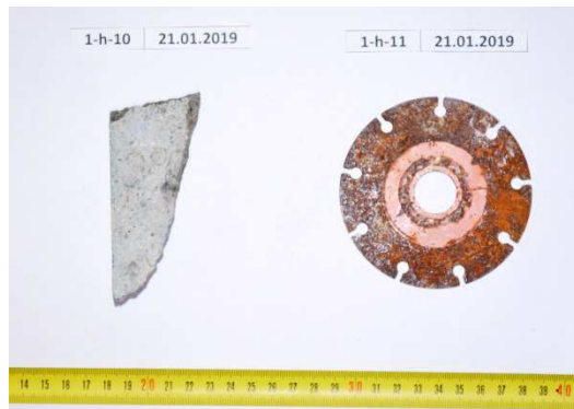
Д.2.11. Сучасний зразок талькохлориту - плитки абощо, та круг від болгарки що нею імовірно місцеві нею ріжуть камені, руїни Нагарешвара поруч Хойсалешвара
