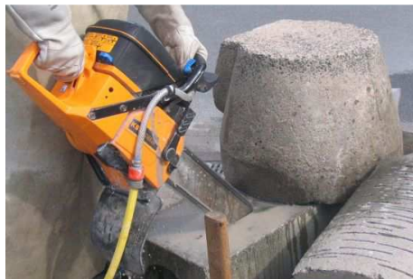
Рис. 7.3.4. Сучасні варіанти мобільних пристроїв-пилок для різання каменю: дискова, стрічкова (ланцюгова), ножівкова
