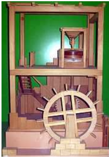
Рис. 7.3.17. Модель зернового млину римського типу за Ветрувієм із приводом від водяного колеса із зубчастим механізмом (нижній поверх); Схема римської лісопилни у Hierapolis, найдавнішої відомої машини, що включає кривошипно-шатунний механізм (друга половина 3 ст. Н.Е.) [35]
