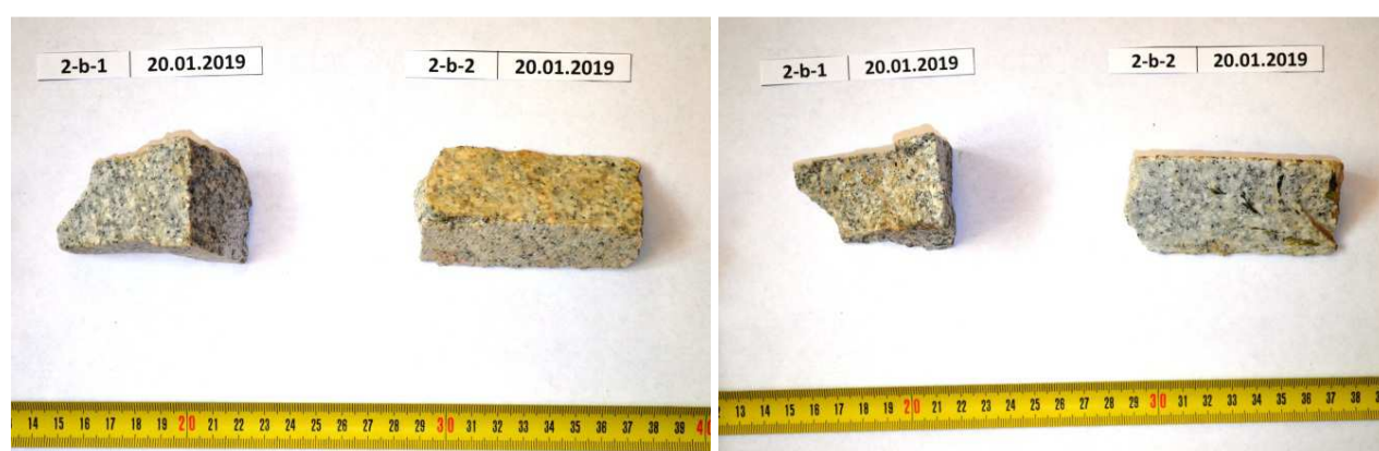
Д.2.2. Зразки світло сірого граніту, оброблений циркулярною пилою із місцевого підприємства з розпилу каменів біля 500 м від гори
