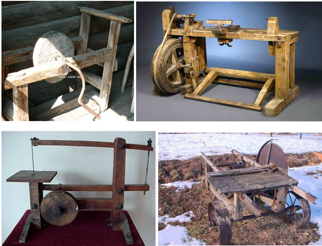
Рис. 7.3.13. Найпростіший шліфувальний (заточний) верстат, Токарний верстат з ножним приводом, Верстат-лобзик, Пересувна циркулярна пила
