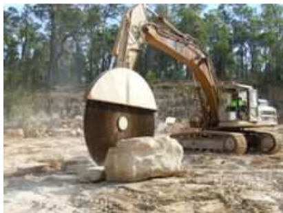
Рис. 7.3.4. Сучасні варіанти мобільних пристроїв-пилок для різання каменю: дискова, стрічкова (ланцюгова), ножівкова
