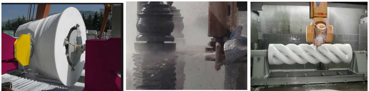
Рис. 7.3.14. Обробка масивних форм обертання (колон) у сучасних умовах: Токарні станки із дисковим різцем з швидким обертанням та повільним обертанням заготівки, Водяна пила із повільним обертанням заготівки, 5Д токарні станки із обертовою швидко рухомою голівкою та повільним обертанням заготівки
