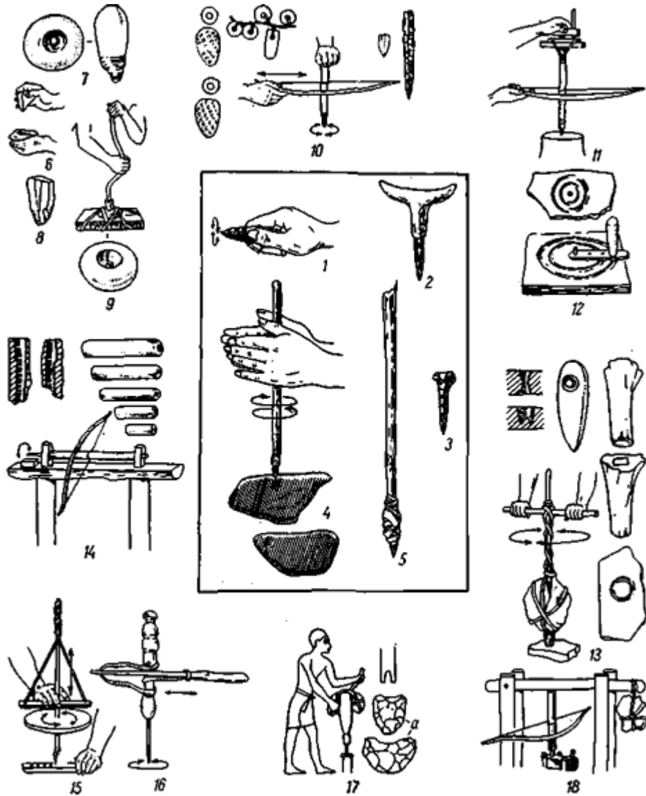
Рис.7.3.2. Розвиток техніки свердління каменю: 1 - одноручне свердління (без рукоятки); 2, 3 - свердло з рукоятками; 4 - дворучне свердління (свердло на стрижні); 5 - свердло (Нова Гвінея); 6 - пікетаж - пробивання отвору в камені дрібними ударами; 7 - розгортання отворів (Вой-Наволоок); 8 - кремнієва розгортка з Нарви I; 9 - свердління булави коловоротом (експеримент); 10 - свердління лучковим свердлом із раковини бус і підвісок; 11 - лучкові пристосування до циркулярного станка для нарізки нефритових скроневих кілець (експеримент); 12 - спрощена модель циркульного верстата для нарізки скроневих кілець (експеримент); 13 - трубчастий свердління з вантажем на стрижні (порожнистий бур з трубчастої кістки, експеримент); 14 - верстат для циліндричного свердління (експеримент), 15 - дискове свердло; 16 - лучкові свердла для циліндричного свердління (Північна Азія); 17 - свердління кам'яних судин в Стародавньому Єгипті (а - форма крем'яних бурів); 18 - верстат для циліндричного свердління кам'яних сокир, по Фореру [12].
