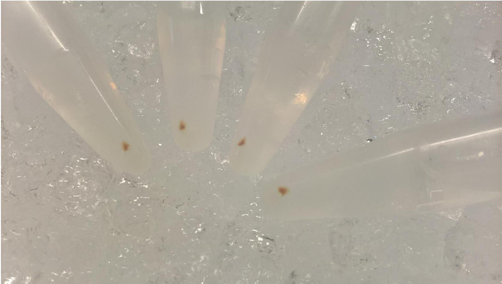
Удаление осаждающего раствора в отдельную большую пробирку.
