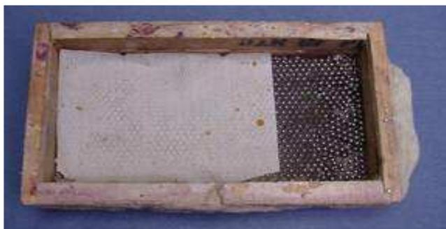
**Фото 40. Протипіхотний СВП, замаскований під цеглину**
